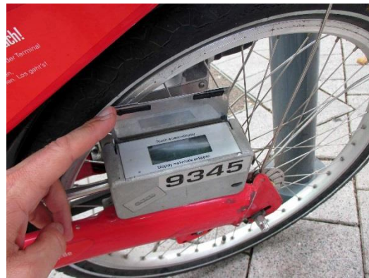
Ein Sperrschloss nimmt den Sperrriegel auf, ein Touchscreen zeigt die wichtigsten Vorgänge an
