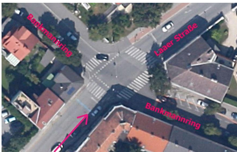
Bild 3: Kreuzung Laaer Straße - Bankmannring: problematisches Linksabbiegen und gefährliches Erreichen des bestehenden Radweges
